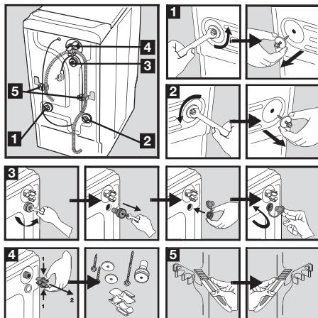
Для того чтобы установить стиральную машину вровень с окружающей мебелью, действуйте, как показано на рис. 5.
